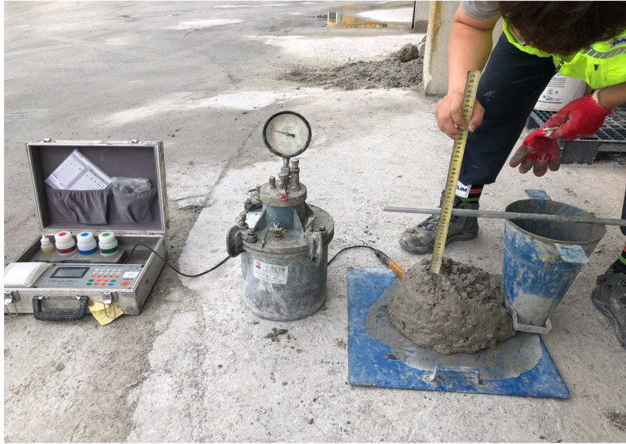
라이닝 콘크리트 슬럼프 시험
